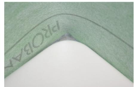
Von oben prüfen und sicherstellen, dass die Anformung dicht und geschlossen mit dem Butylstreifen vorliegt.
