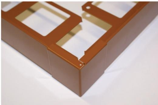
Profilen in den Eckverbinder ein-setzen. Loch nach oben. Mind. 8 mm Abstand zwischen den Profilen
