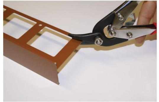
Mit Säge oder Blechschere beide Auflageschenkel im Anbindungs-bereich auf Gehrung schneiden.
